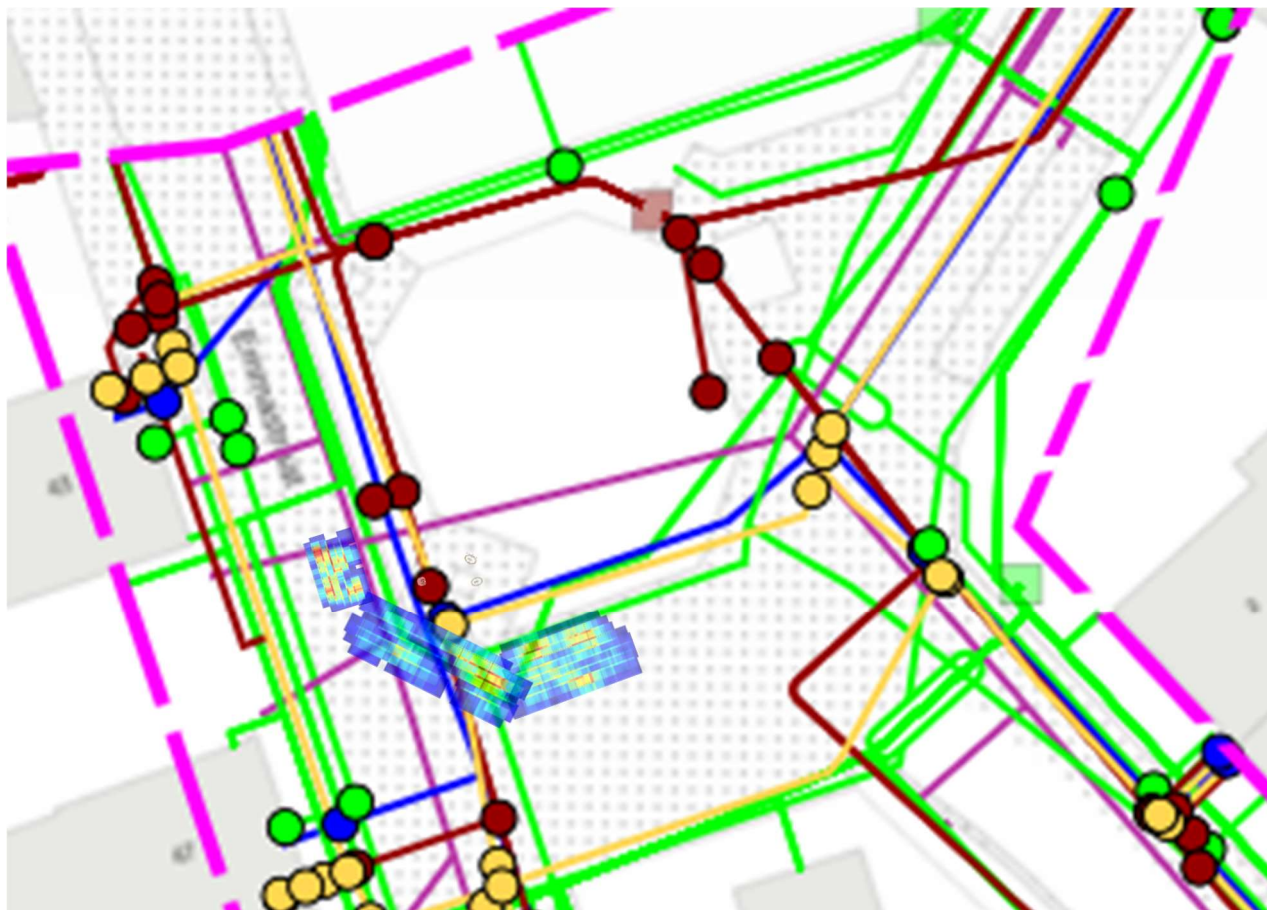
Figuur 10: Wortelintensiteit gelegd over de klimmelding. Op deze locatie een knooppunt van nutsvoorzieningen.
