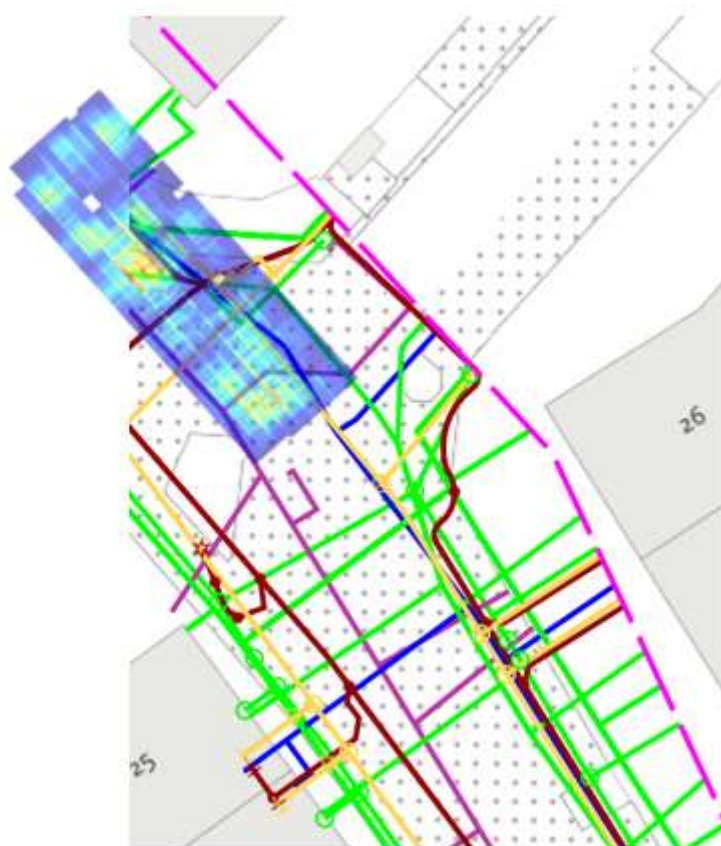
Figuur 3: wortelintensiteit geprojecteerd op de digitale ondergrond van de locatie van de boom. Hoe roder des te meer beworteling, de lichte plekken geven aan dat daar geen beworteling is waargenomen.
