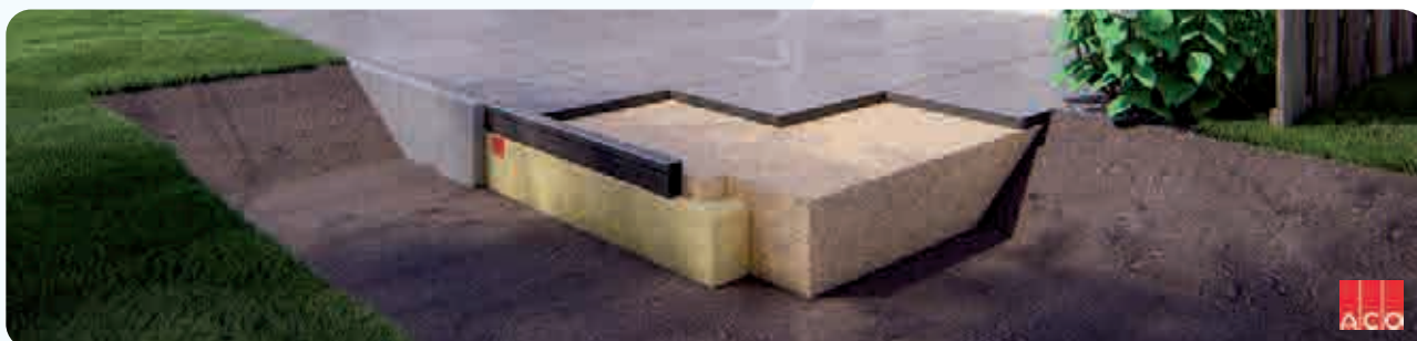
Infiltreren onder een lijngoot
